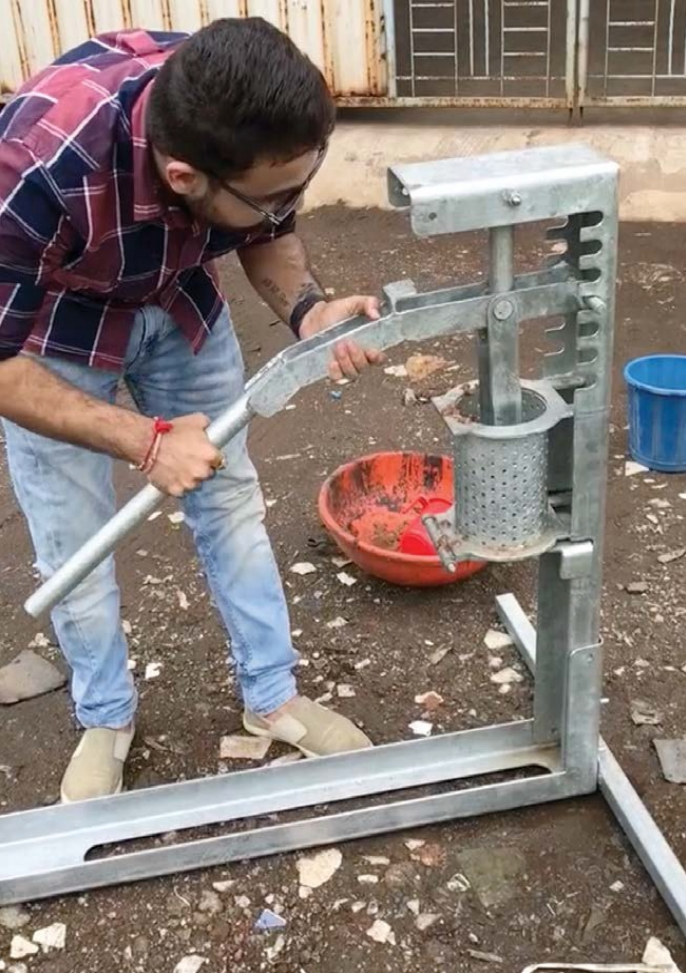
ब्रिकेटिंग मशीन कृषी करच्या ब्रिकेट मध्ये रूपांतर करत आहे ज्याचा वापर स्वयंपाकासाठी इंधन म्हणून केला जातो
